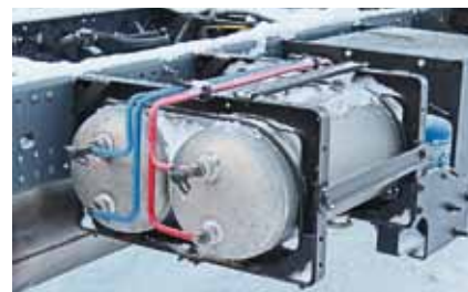
Ресиверы тормозной системы из нержавеющей стали на правой стороне рамы
