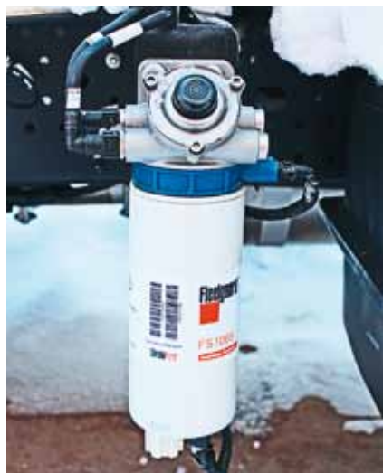
Топливный фильтр-сепаратор с подкачной помпой
