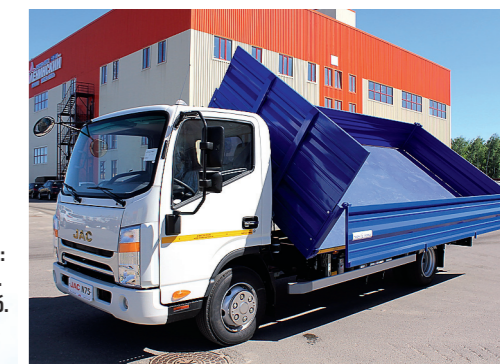
▲ JAC N75 – полная масса до 7,5 т (грузоподъемность 4,5 т), к концу года появится пятитонная N80. Силовой агрегат: 156-сильный Cummins (490 Нм) с 6-ступенчатой МКП. Цена шасси – от 1,8 млн рублей
